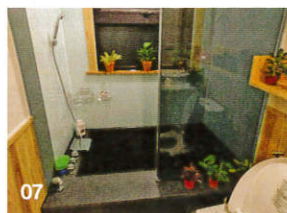
07 乾濕分離的衛浴廁所，地板使用塑木，避免冬地板導熱快的冰冷感，同時方便拆洗。
